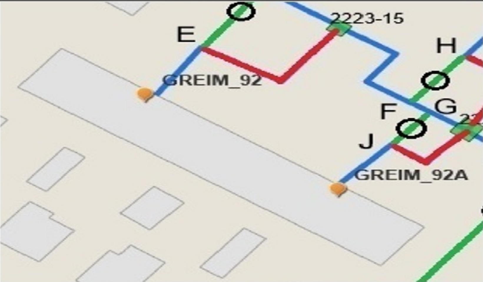
Vidaus tinklų aksonometrija nuo pastato sienos iki įvadinių sklendžių Nr.1 ir Nr.2
