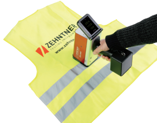
Versions with observation angle \alpha 0.2^\circ are suitable for measuring safety garments / Ausführungen mit Beobachtungswinkel \alpha 0.2^\circ sind geeignet zur Messung von Warnkleidung
