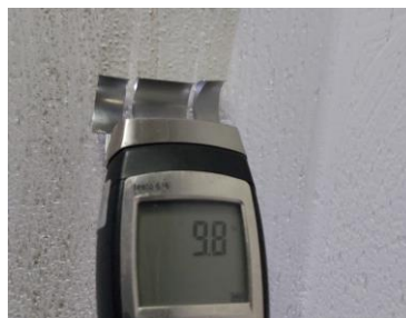
76 pav. Rūšio patalpos tarp ašių „1“–„2“ ir „A“–„B“ sienos ir tinkuotojo paviršiaus drėgmės lygio matavimas: 9,5 ir 9,8 %
