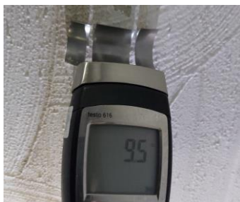
76 pav. Rūšio patalpos tarp ašių „1“–„2“ ir „A“–„B“ sienos ir tinkuotojo paviršiaus drėgmės lygio matavimas: 9,5 ir 9,8 %
