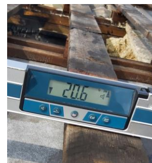
55 pav. Orientacinis stogo nuolydžio tikrinimas tarp ašių „1“–„2“ ir „A“–„C“: 20,6 laipsnių (projekte nurodytas 20 laipsnių nuolydis)
