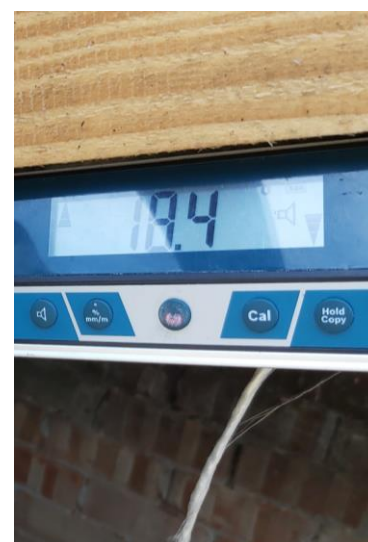
57 pav. Stogo gegnių nuolydžio tikrinimas tarp ašių „3“–„4“ ir „C“–„D“: 18,4 laipsnių (projekte nurodytas 20 laipsnių nuolydis)
