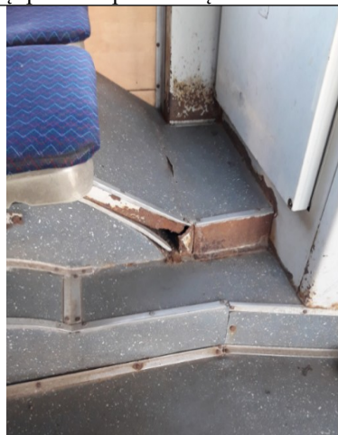
3 pav. Transporto priemonės salono elementai paveikti korozijos, netvarkingi, blogos estetinės būklės
