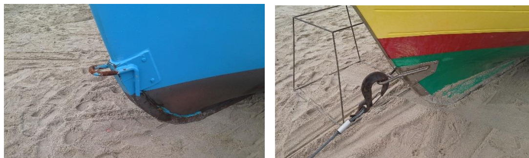
12 pav. Prie laivo galo pritvirtyta kilpa įtraukimui į jūrą
