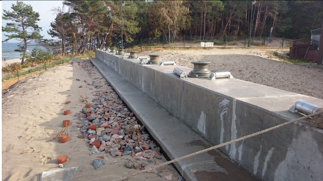
4 pav. Lyno traukimo įrenginys (elektrinis su mechanine pavara)
