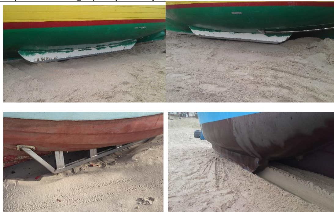
10 pav. Prie laivo dugno pritvirtintas kaustyta šliužė
