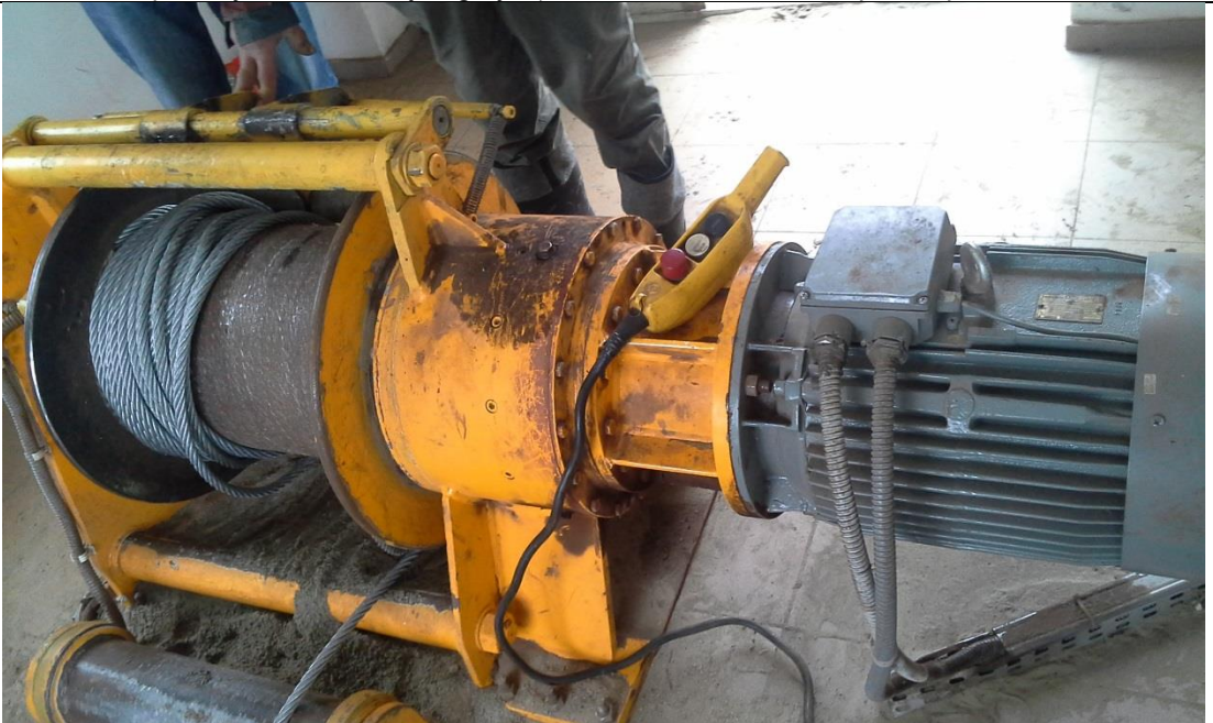
4 pav. Lyno traukimo įrenginys (elektrinis su mechanine pavara)
