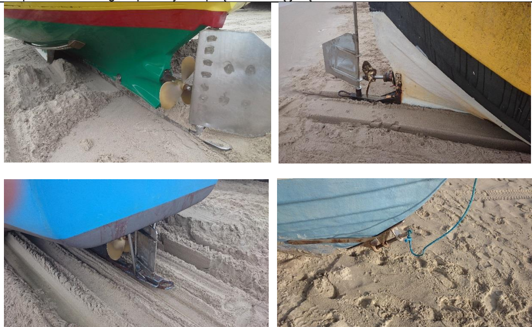
12 pav. Prie laivo galo pritvirtyta kilpa įtraukimui į jūrą
