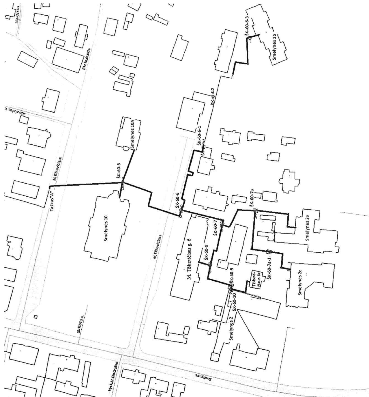
Šilumos tinklų nuo taško „A“ iki smėlynės g. 2a ir iki Smėlynės g. 2b su atšakomis situacijos schema
