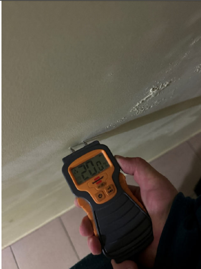
Pamatuota drėgmė pusrūsio sienose (Patalpa P-52)
