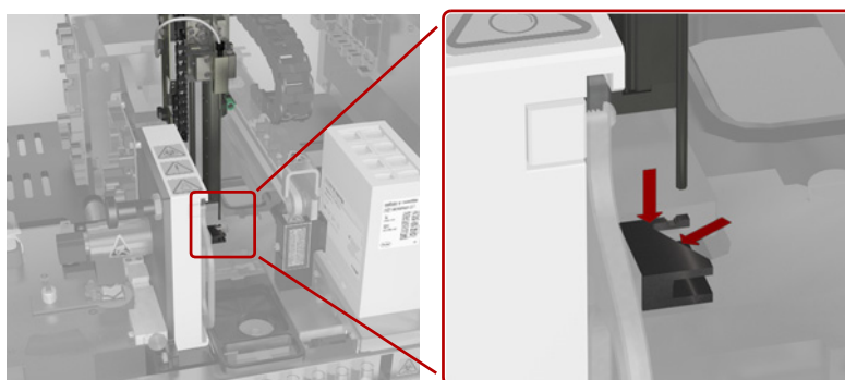
Paveikslėlis 3-20 Tyrimo juostelių analizatoriaus sulinkusios adatos detektorius
