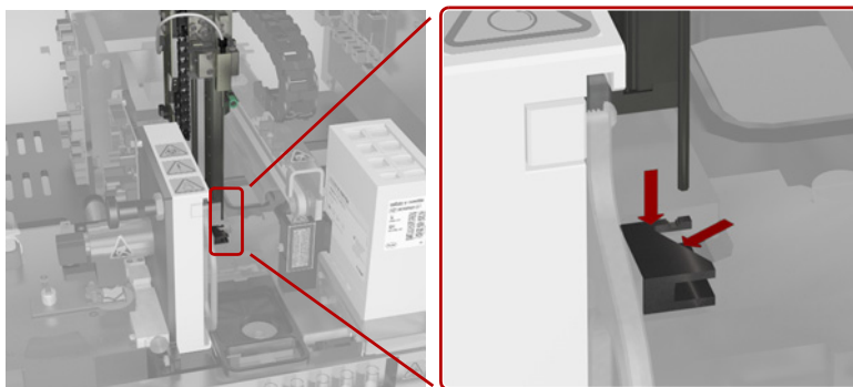
Paveikslėlis 5-41 Mikroskopijos analizatoriaus sulinkusios adatos detektorius
