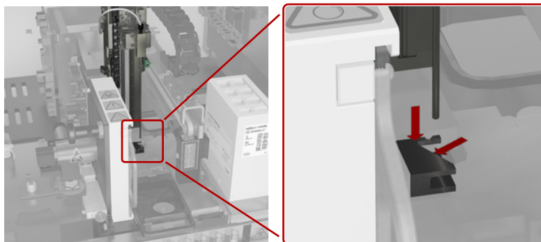
Paveikslėlis 3-19 Mikroskopijos analizatoriaus sulinkusios adatos detektorius
