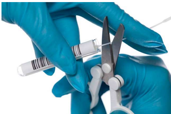
Pav. 11. Tampono kotelio nukirpimas, laikant jį mėgintuvėlyje.
