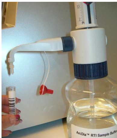
Pav. 20. Dozavimas butelio dozatoriumi.
