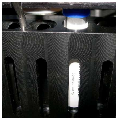
Pav. 14. Tinkama mėgintuvėlio pozicija mėgintuvėlių stovė.
