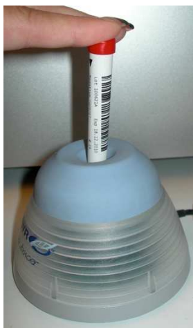
Pav. 24. Kontrolinių mėginių maišymas ir laikymas 2-10 minučių.
