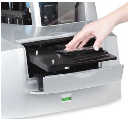
Pav. 25. Tyrimo plokštelės įdėjimas į plokštelės laikiklį.
