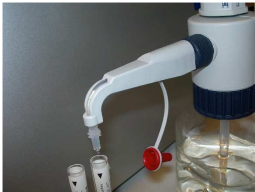
Pav. 23. RTI mėginio buferio dozavimas į kontrolinių mėginių mėgintuvėlius.
