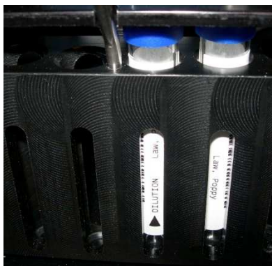
Pav. 21. Tinkamas mėgintuvėlių įdėjimas į stovą.
