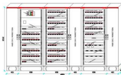
FRONTE QUADRO Q.B2 QUADRO DI NUOVA INSTALLAZIONE
