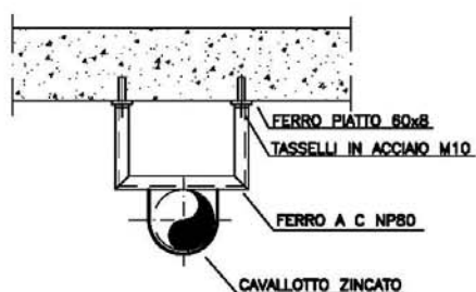
PARTICOLARE SUPPORTO MONTANTE (tipico)
