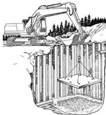
Fig. 4 Pamato plokštės nuleidimas
