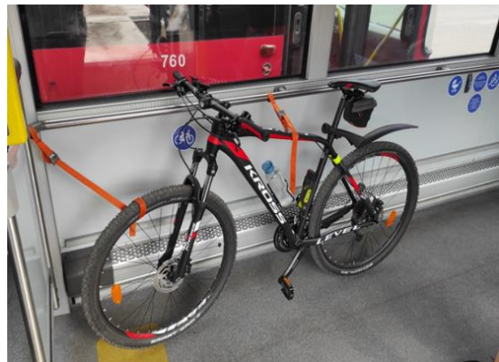
Tinkamai įrengta ir paženklinta transporto priemonė dviračiams vežti.
